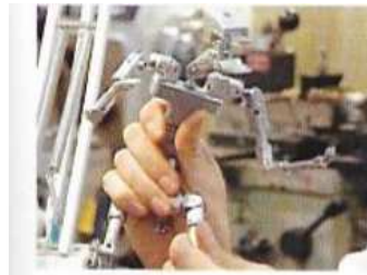
Armatur (bewegliches Stahlskelett). Mit Scharnieren und Gelenken bleiben die Puppen für die spätere Stop motion-Animation stabil und trotzdem formbar.
